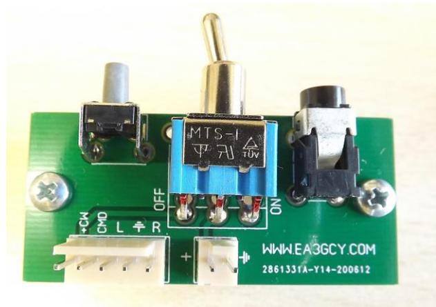
Efectúe las conexiones desde el zócalo de 5-pin al zócalo de la placa "CW Interface".
