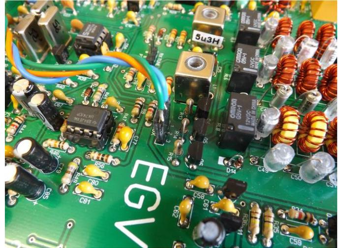
⇒ **Wire the P6 RX pass-band potentiometer.**
