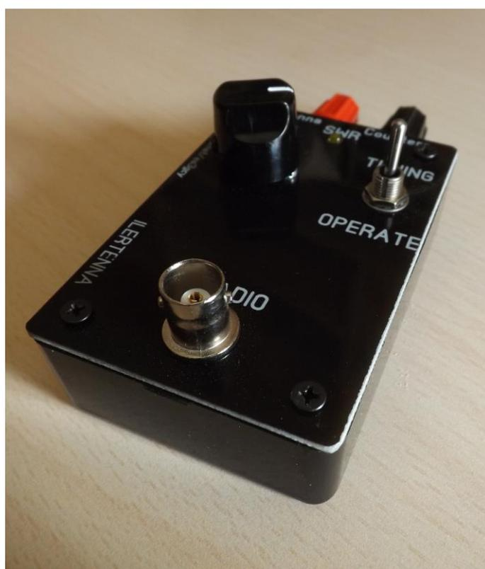
Gracias por construir el kit sintonizador de antenas “*end-fed*” QRP **ILERTENNA**
