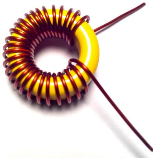
Bobine las espiras con fuerza, de forma que sigan el contorno del toroide y queden los más ajustadas posible a él. Las vueltas deben quedar uniformemente distribuidas en toda la circunferencia del toroide. Deje unas puntas de unos 10mm. Rasque con un "cutter" las puntas para que el hilo pueda soldarse en la placa.
