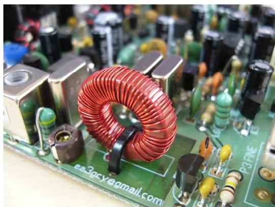
Para facilitar el trabajo, L5 puede bobinarse en dos etapas. Pase la mitad del cable a través del toroide, bobine la mitad del toroide y luego gire el toroide y bobine la otra mitad. Si tiene dudas de cuantas vueltas ha dado, con una lupa y una buena luz podrá contarlas fácilmente.
