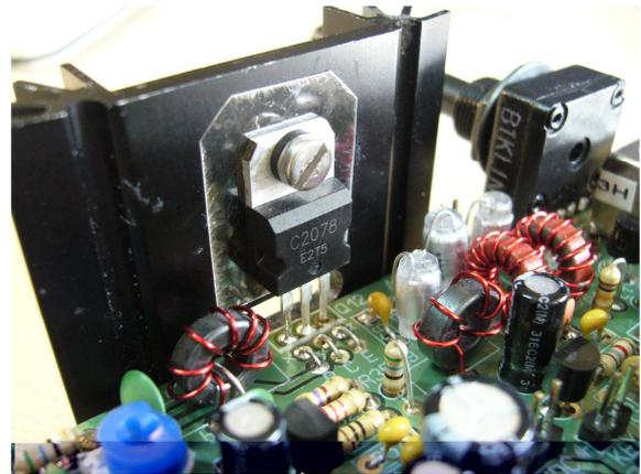
**NO opere el transceptor sin sujetar Q12 a un radiador.**
