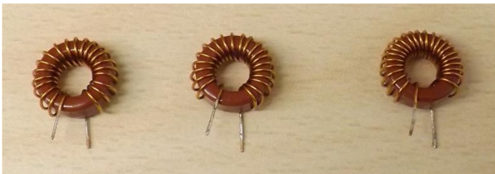
Toroides L1 - L3 - L2 (L4 - L5 - L6) para 80m
